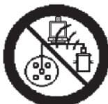
Installare lontano dalla bobina di accensione e passare il cablaggio lontano dai cavi dell'alta tensione.
