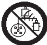
Instalar lejos de la bobina de encendido y pasar el cableado lejos de los cables de alta tensión.
